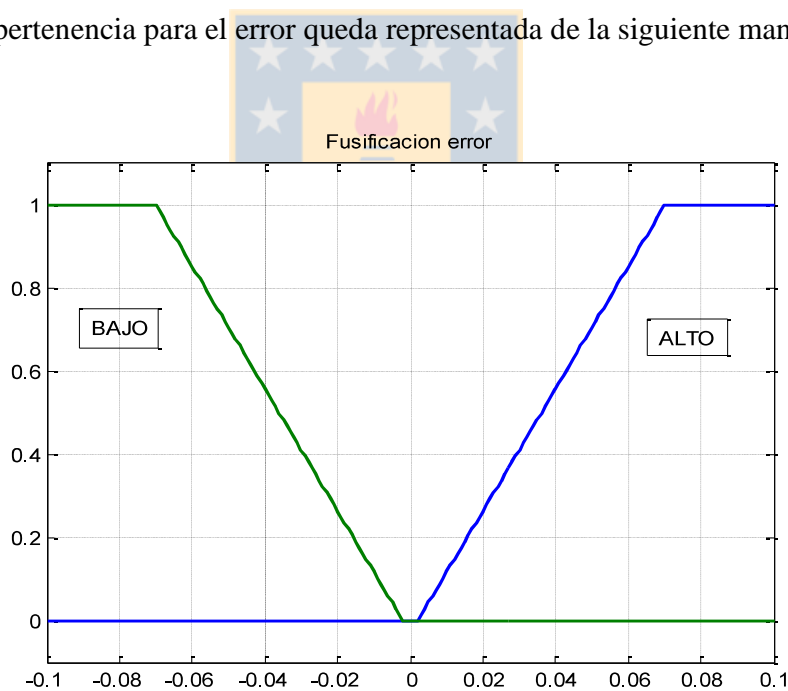
Fig.7.4) Fusificación de la entrada al controlador
