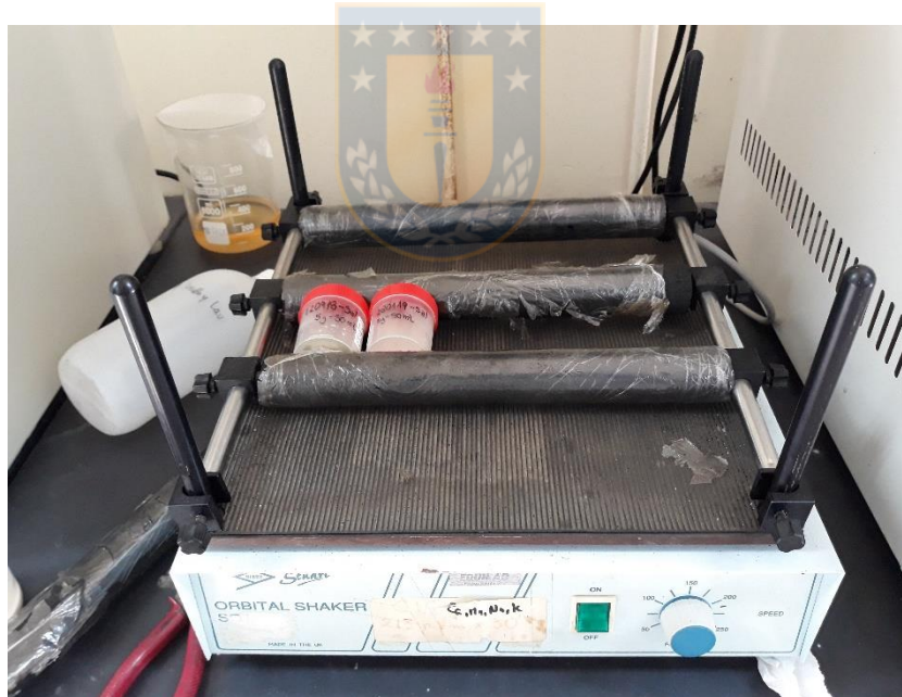
Figura C- 1: Agitación mezcla salmuera-zeolita.
