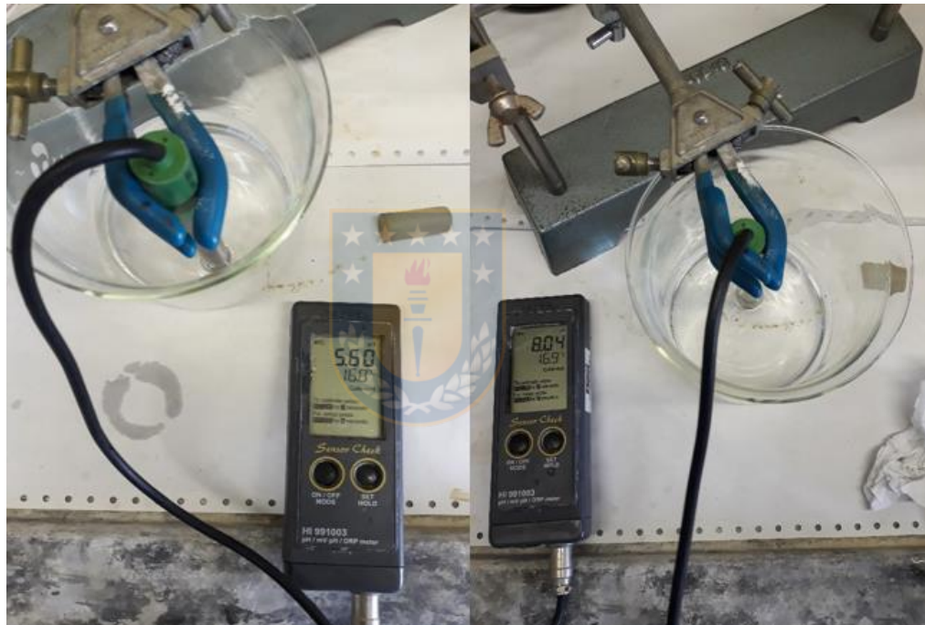
Figura B- 1: Ajuste de pH, pH inicial (figura izquierda), pH final (figura derecha).
