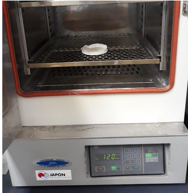
Figura A- 5: Secado de muestra luego de la limpieza y filtración al vacío.
