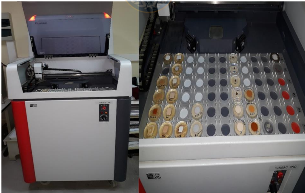
Figura 3.1–1: Equipo de DRX Bruker axs D4 Endeavor, ubicado en el instituto GEA de la UdeC. Vista de equipo completo (figura izquierda), vista de porta muestras (figura derecha).
