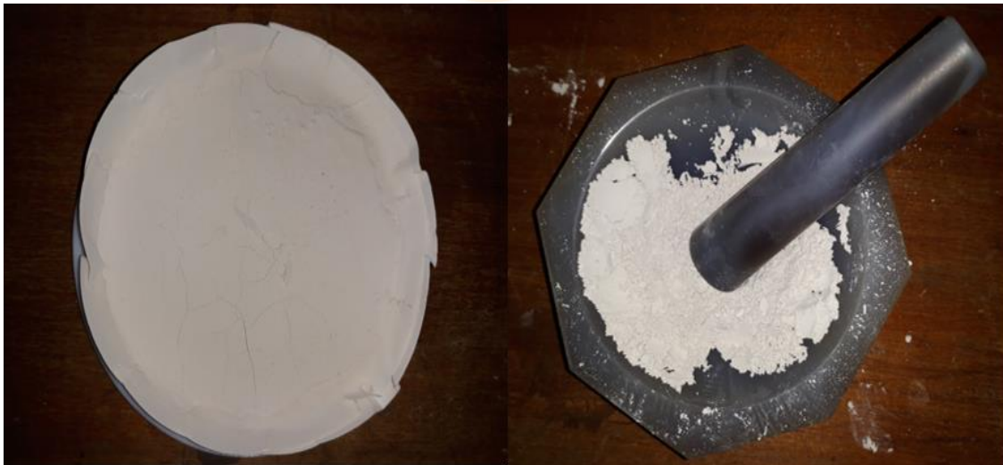
Figura A- 6: Muestra sólida molida después del secado en la estufa.
