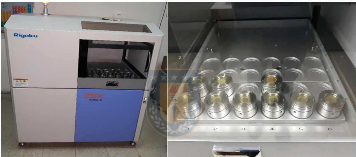
Figura 3.1–2: Equipo de FRX Rigaku ZSX Primus II, ubicado en el instituto GEA de la UdeC. Vista de equipo completo (figura izquierda), vista de porta muestras (figura derecha).
