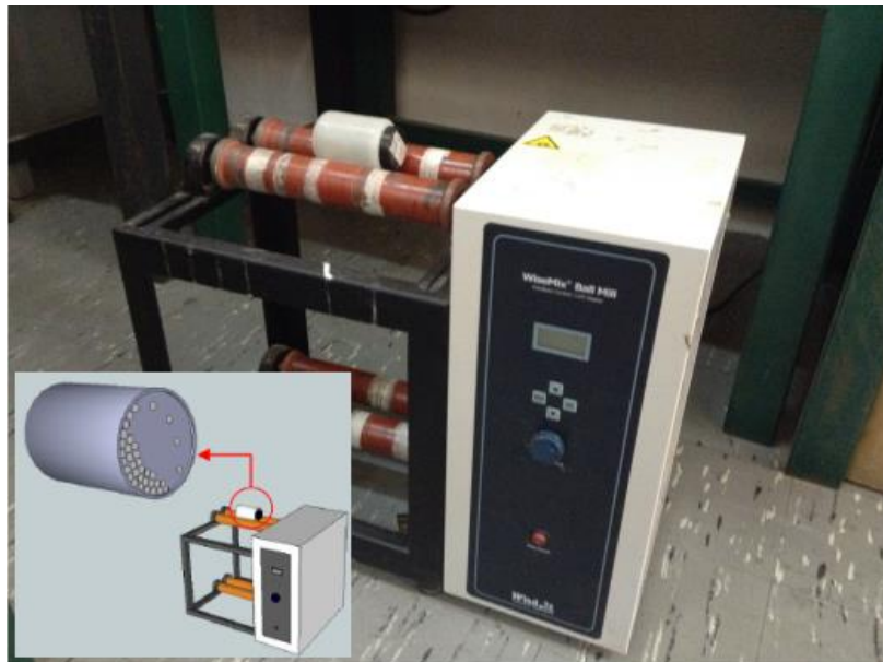
Figura 12. Mezclado físico en molino de bolas ( Wisemix Ball Mill® ). Fuente: Elaboración propia
