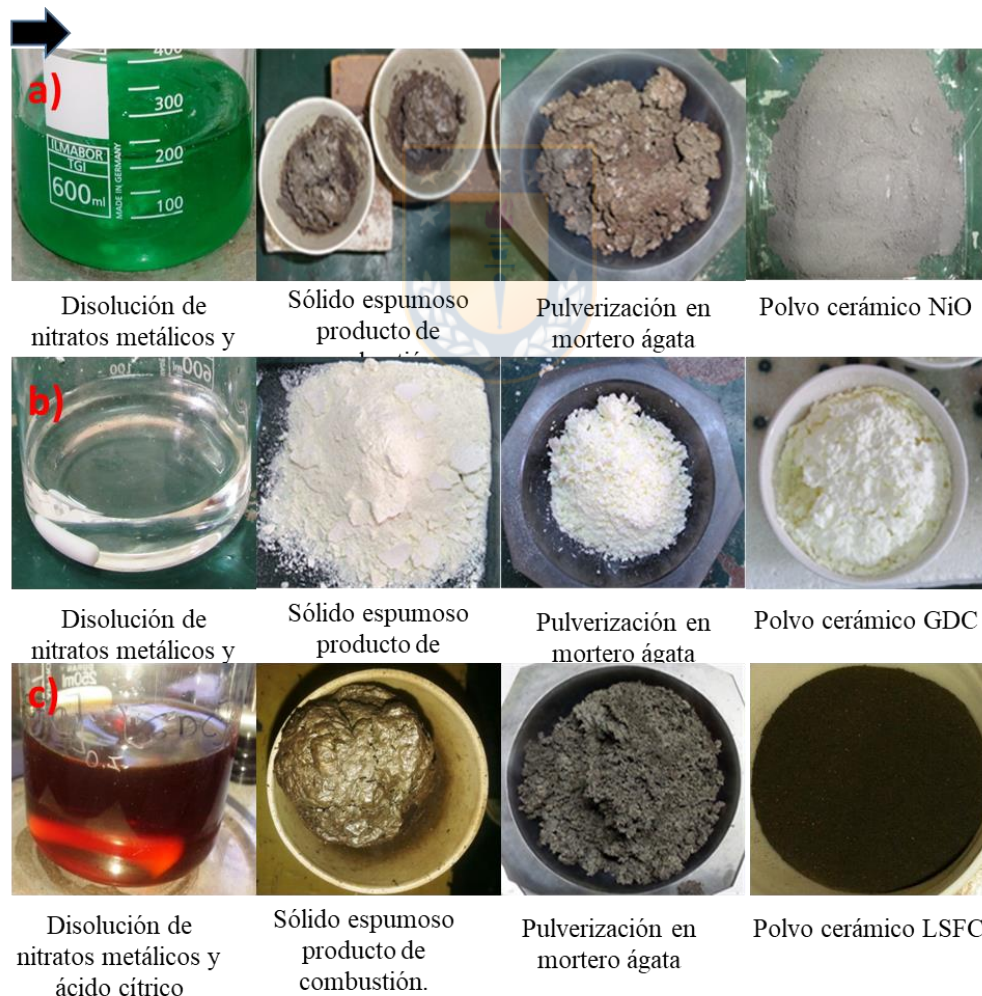
Figura 11. Síntesis de polvos cerámicos por solución combustión. a) NiO, b) CGO, c) LSFC. Fuente: Elaboración propia
