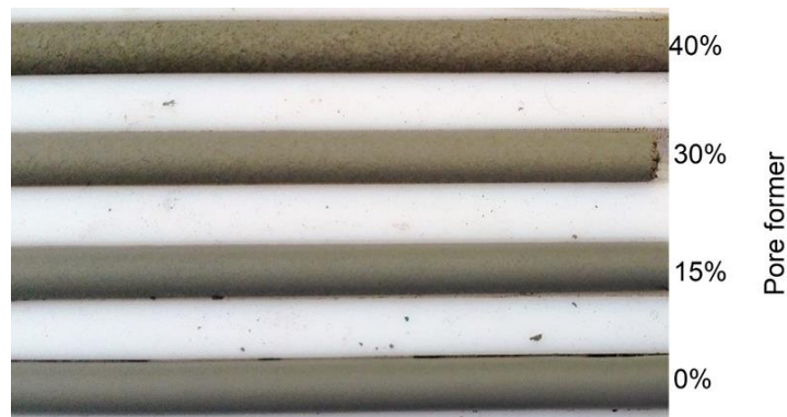
Figura 14. Microtubos en verde para diferentes cantidades de formador de poros. Fuente: Elaboración propia
