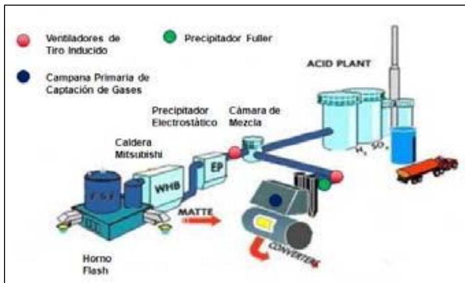
Figura 3 diagrama del tren de gases Fuente: COCHILCO
