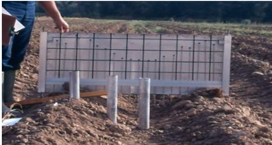
Figura 3. Técnica del perfilómetro para determinar la geometría del surco. Fuente: Holzapfel (2020b).
