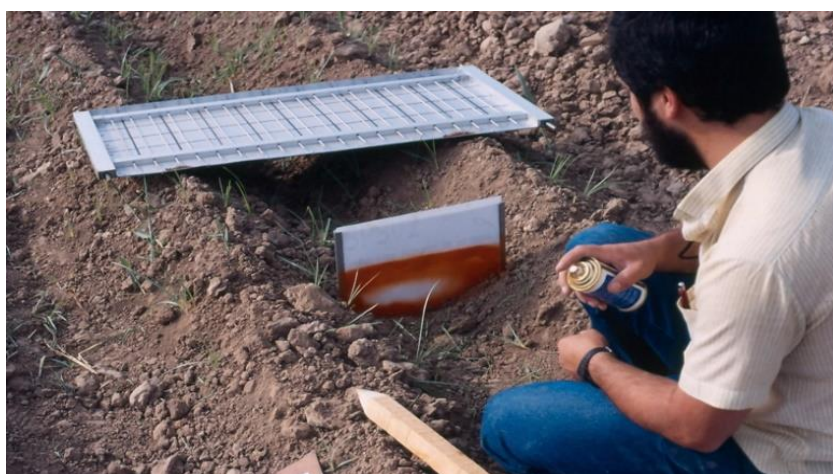
Figura 2. Técnica para determinar la geometría del surco pintando el entorno de surco. Fuente: Holzapfel (2020b).
