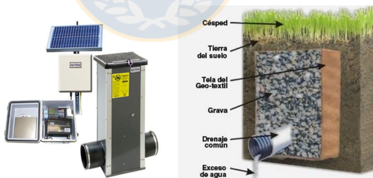
Figura 26. Compuerta de control del nivel freático con un sistema electrónico y perfil de un dren francés. Fuente: Elaboración propia.
