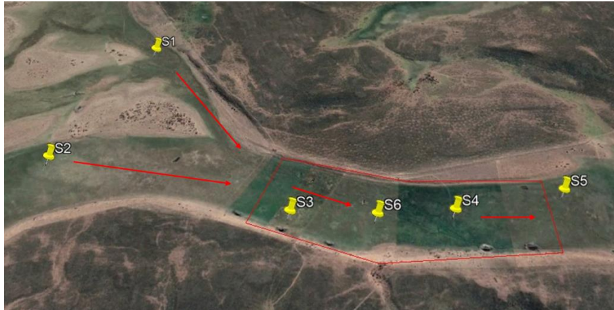
Figura 6. Área de estudio, donde los puntos amarillos indican las ubicaciones de los sensores de nivel freático, el polígono rojo muestra la Vega estudiada y las flechas rojas la dirección de flujo de aguas subterráneas. Fuente: Ivelic-Saez et al., 2021.
