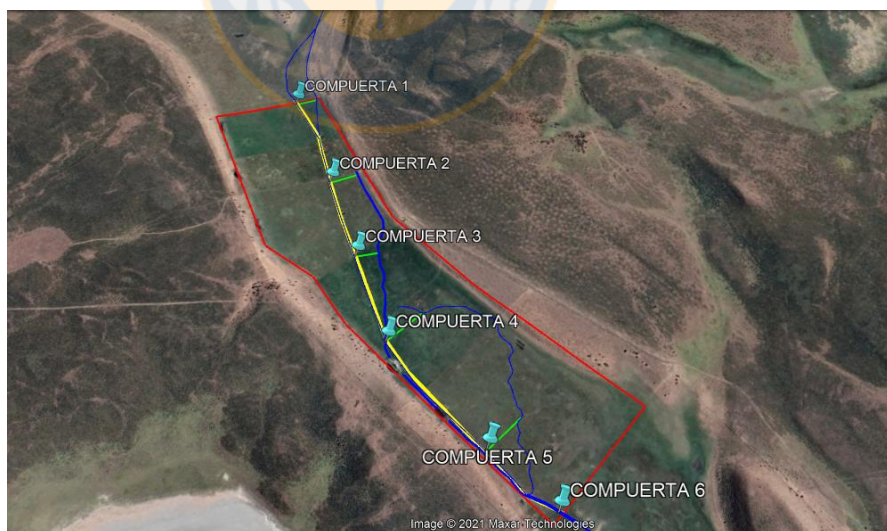
Figura 28. Ubicación de compuertas verticales (puntos celestes) en el canal de drenaje principal (línea amarilla), canales de drenaje secundarios (línea azul) y distancia entre drenes (línea verde). Fuente: Elaboración propia.
