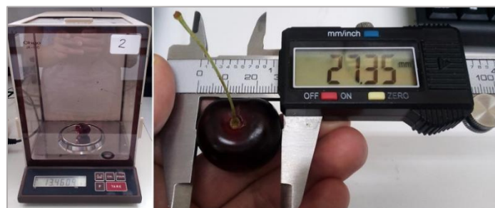
Figura 3.8. A la izquierda, la medición de la masa con la balanza de precisión, y a la derecha la medición de diámetro con el pie de metro digital. Fuente: Elaboración propia.
