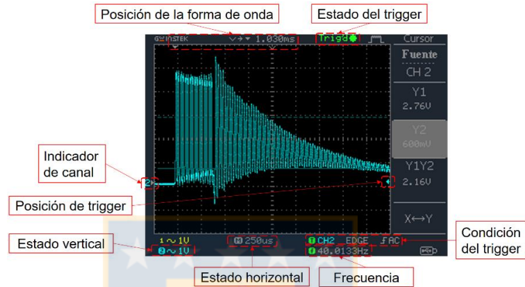
Figura 3.2. Descripción de la pantalla del osciloscopio. Fuente: Elaboración propia.
