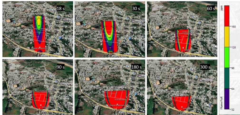
Figura 17. Comportamiento de las modelaciones realizadas con el Software Slab View para fugas de Anhídrido Sulfuroso en punto 3.
