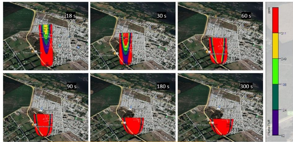
Figura 33. Comportamiento de las modelaciones realizadas con el Software Slab View para fugas de Sulfuro de Hidrógeno en punto 4.
