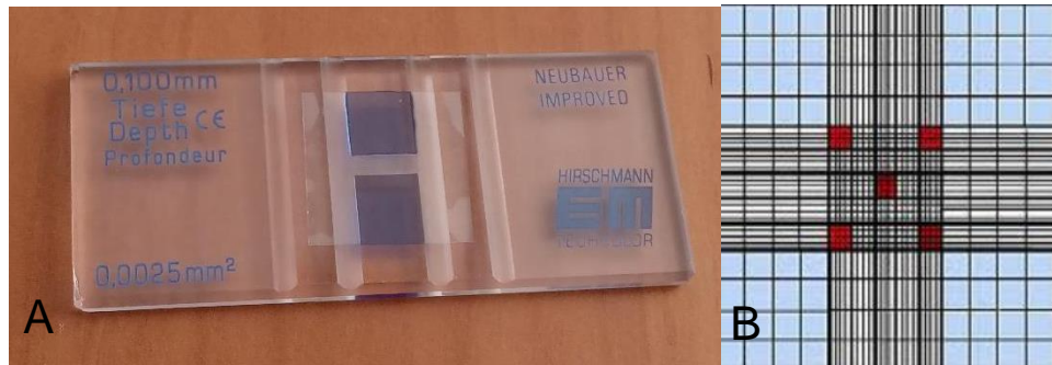
Figura 12: A) Cámara Neubauer utilizada para el conteo de eritrocitos y leucocitos cargada con la solución de sangre más la tinción Res-Ecker. B) Cuadrantes utilizados (en rojo) para el conteo de eritrocitos.
