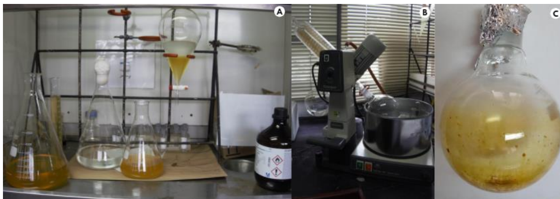
Figura 7. Etapas para la obtención del extracto total. A) separación líquido y filtración de la fase orgánica, B) sequedad al rotavapor C) Extracto total
