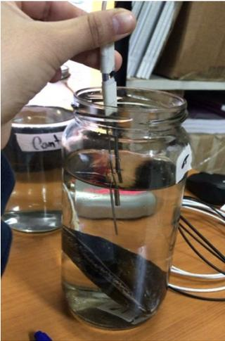
Figura 3. Sonda midiendo oxígeno disuelto de individuo de *Mytilus galloprovincialis* dentro de cámara respirométrica.
