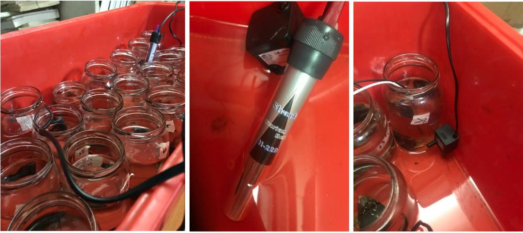
Figura 4. Cámaras respirométricas dentro de estanque con agua, reguladores de temperatura y bomba de agua.
