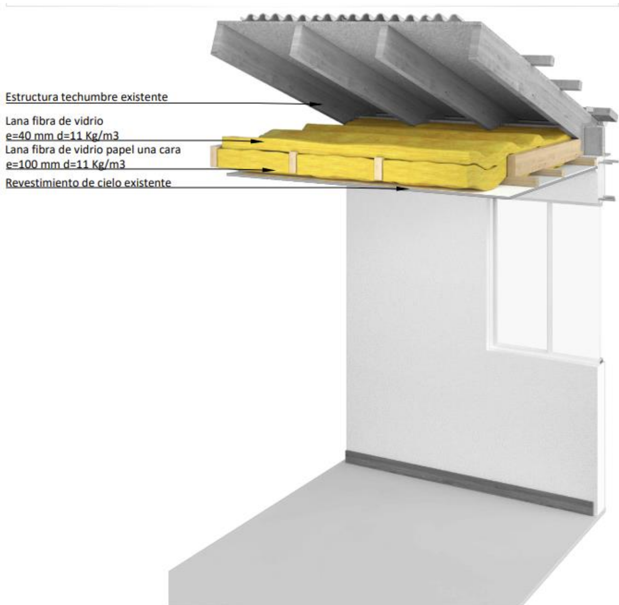
Figura 22: Solución constructiva para cielo falso
