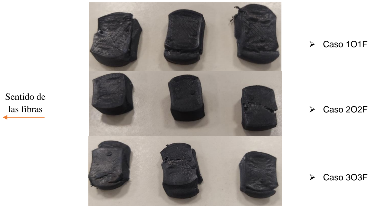
Figura 4.5: Especímenes ensayados en compresión interlaminar.
