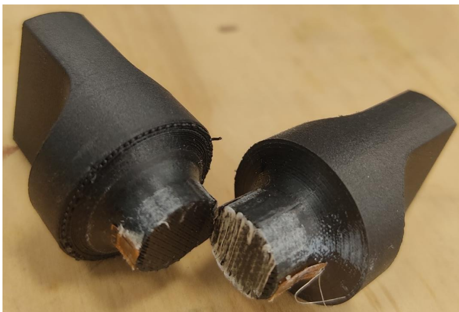
Figura 4.2: Modo de falla de las probetas del ensayo de tracción fuera del plano.
