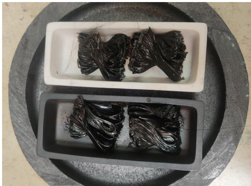
Figura 4.12: Probetas tratadas térmicamente a 200°C durante 1h.
