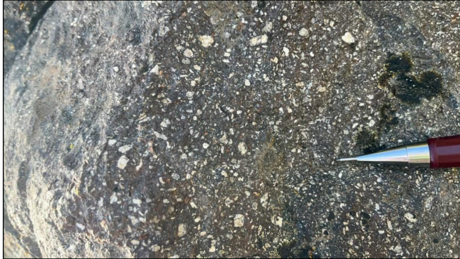
Figura 3.9: Detalle andesitas de la Fm. Cura-Mallín. Se observan los fenocristales de tamaño fino a medio.
