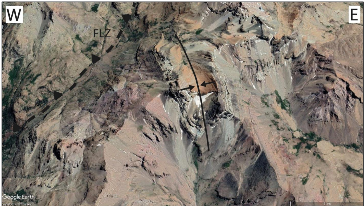
Figura 3.21: Sinclinal de bloque yacente y proyección de FLZ al sur. Se marca la posible traza de la FLZ en el estero La Gloria y el sinclinal formado en el sector del estero Del Castillo.
