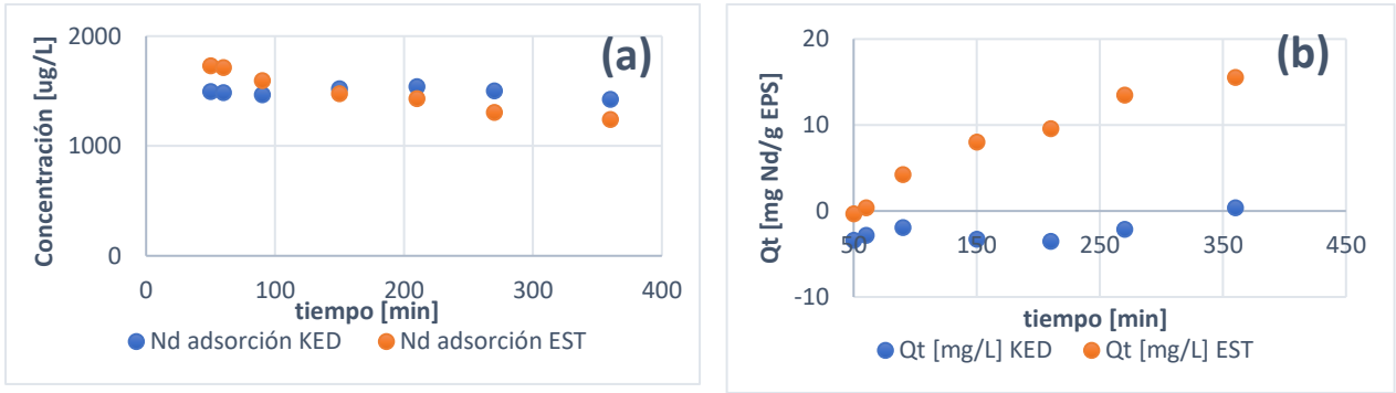
Figura 5.9: Concentración (a), Capacidad de adsorción (b), versus tiempo, de neodimio, a partir de los cincuenta minutos, medidos en modo estándar (EST) y de discriminación por energía cinética (KED).
