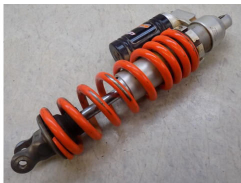
Figura 2.2.2: Suspensión trasera KTM 450 sx-f.[3]
