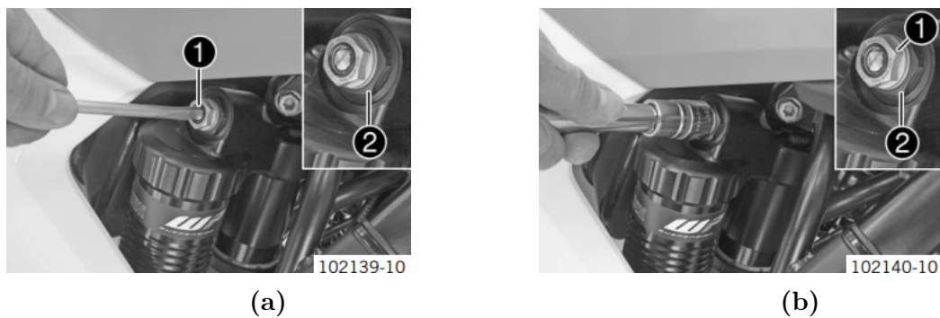
Figura 2.2.6: Regulación (a) baja velocidad (b) alta velocidad.[3]
