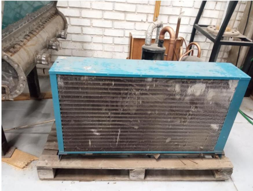
**Figura 9: Condensador de tubo y aletas**
