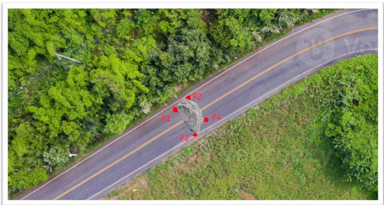
Figura 6.9 Ejemplo de captura para medición del ancho y largo del daño
