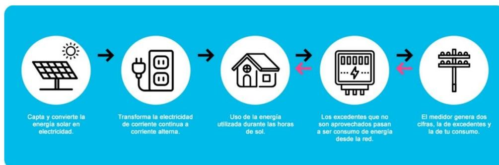
*Figura 2.1 Funcionamiento sistema fotovoltaico según ley 20.571.*
