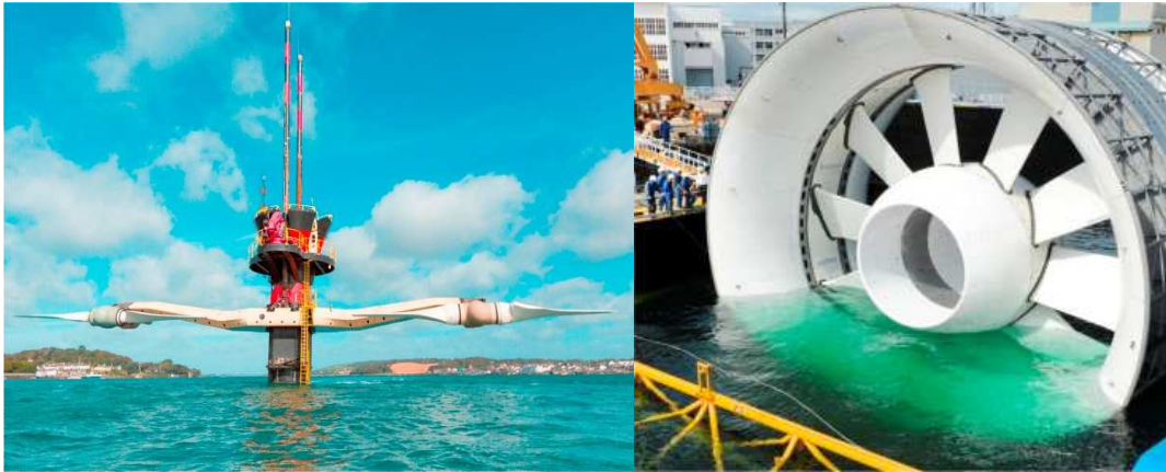
Figura 2.4 Turbina hidrocineética SeaGen S (izquierda) y turbina OpenHydro (derecha)
