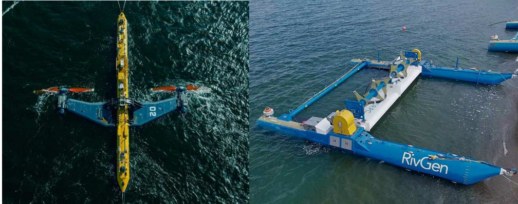
Figura 2.5 Turbina hidrocínética Orbital O2 (izquierda) y turbina hidrocínética RivGen Power System (derecha)
