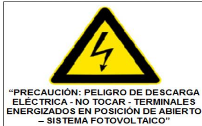
Figura 40: Señalética de seguridad en unidades de generación fotovoltaica
