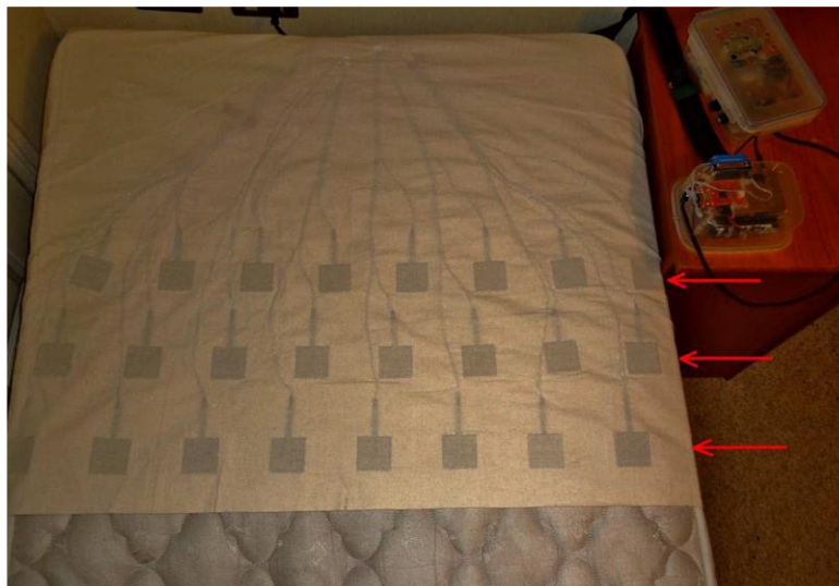
Figura 1: Sabanilla implementada en cama, cada línea roja es una fila de ocho sensores FSR.
