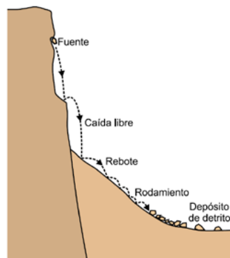
Figura 3. Caída o Desprendimiento
