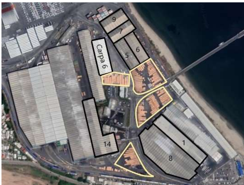
Figura 2.10: Diagrama ilustrativo de las bodegas de acopio y los patios exteriores en el recinto principal del puerto.
