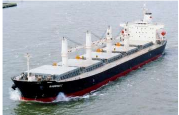
Figura 1.2: Nave break bulk con cuatro grúas Liebherr en cubierta.
