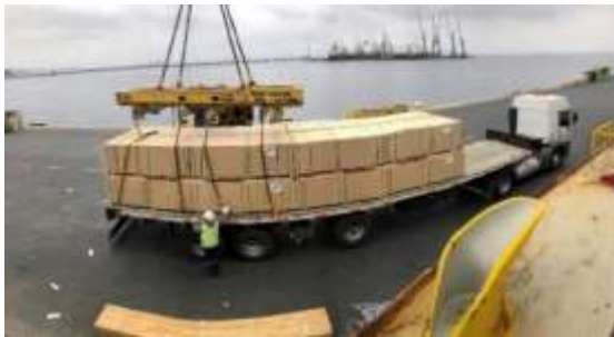
Figura 2.13: Enchance de carga a grúa Liebherr de la nave.
