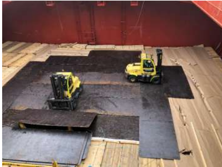
Figura 2.3: Ubicación planchas de hierro cortas en la bodega de la nave.
