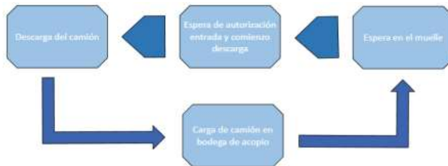
Figura 2.16: Diagrama macro-proceso descarga de camiones en muelle.
