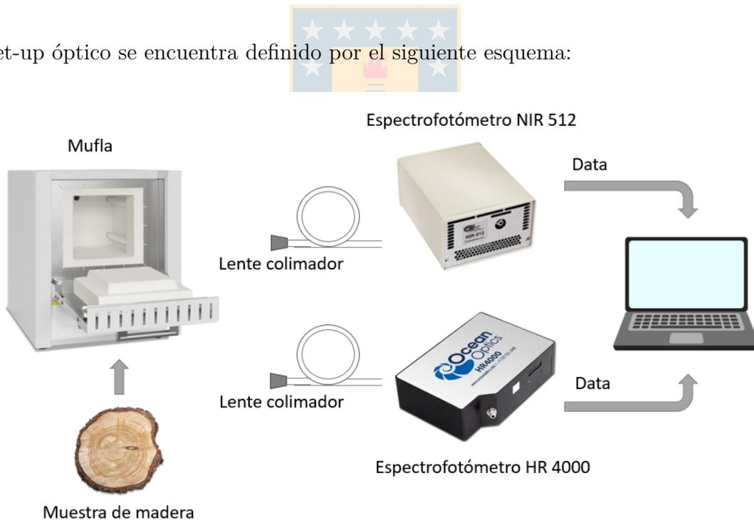
**Fig. 4.10:** Configuración Set-up óptico de mediciones
