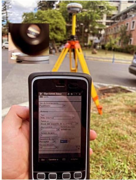
**Figura 21. Montaje equipo GNSS base y configuración Colectora.**
