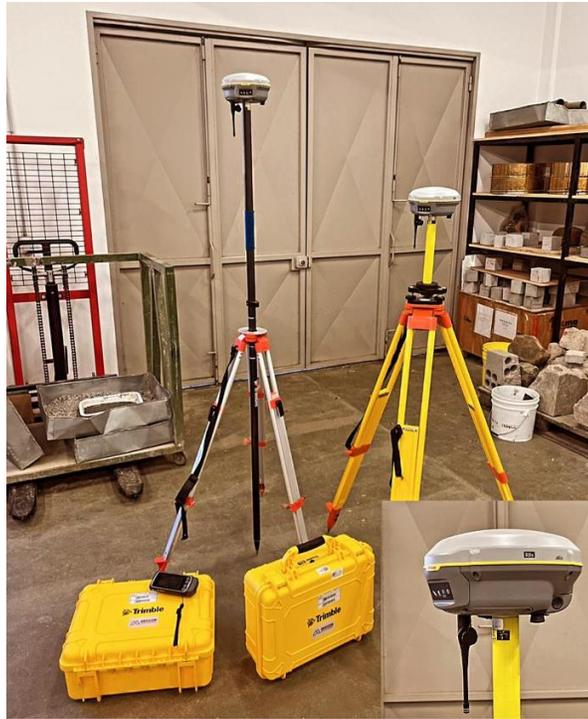
*Figura 18. Sistema GNSS Trimble R8s.*
