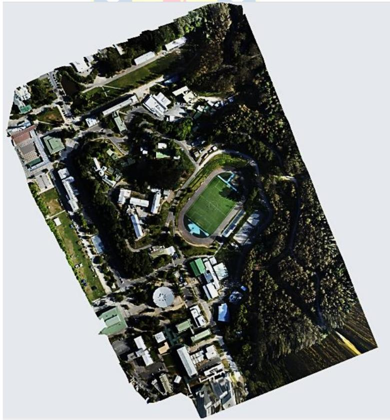
*Figura 27. Ortofotografía generada en PIX4D.*
