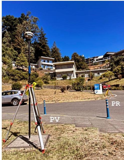
*Figura 28. Medición punto de visado con receptores GNSS Trimble R8s.*
