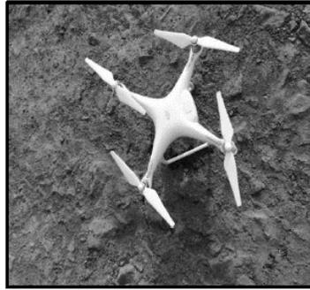
*Figura 14. VANT de ala rotatoria, DJI Phantom 4 Pro. (Fuente: Mantey, 2021).*
