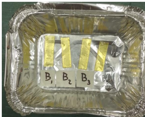
Figura 8.17 Set de muestras de segundo lote de carga 2% NFC en climatización.
