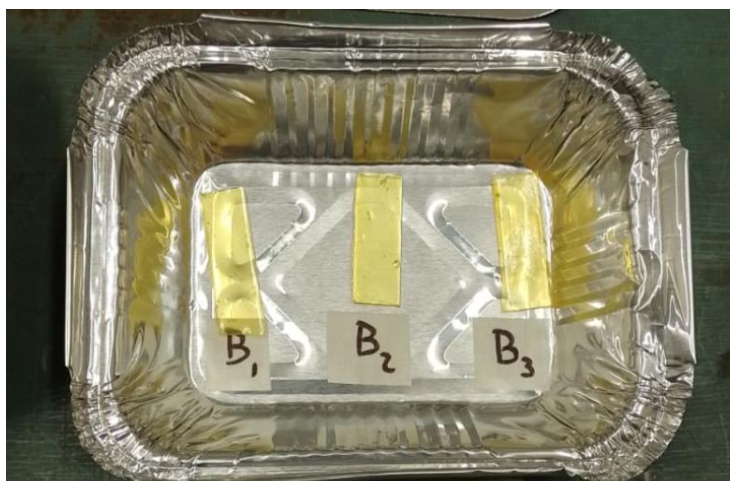
Figura 8.13 Muestras de PGItc/NFC al 2% en climatización, pertenecientes a la síntesis n°9.
