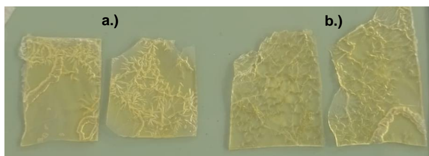
Figura 5.7 Dos sets de muestras para testeo de autocuración, a.) serán juntados por el lado suave, y b.) serán juntados por la cara porosa y con grietas.
