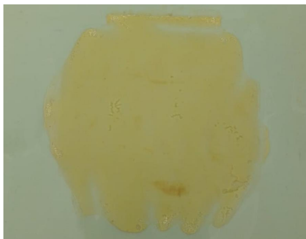
Figura 8.5 PGItc con 1% de NFC dispersado en lámina de silicona.
