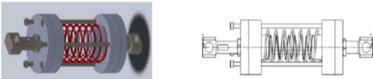
Figura 2.8 Diseño amortiguador masa-resorte con material granular VPP. Zalewski et al. (2016)
