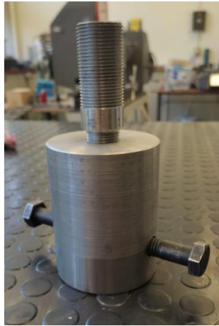
Figura A3.7 Anclaje para celda de carga.
