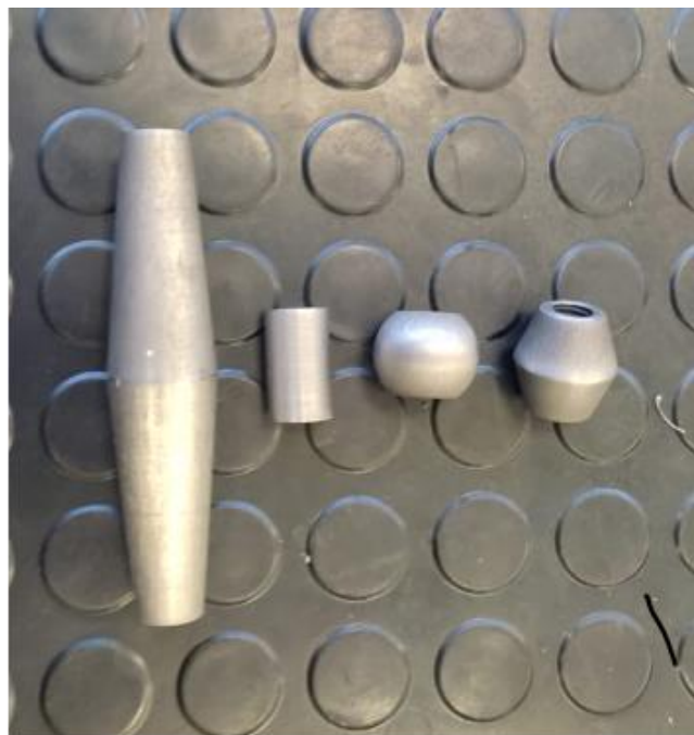
Figura A3.5 Pistones del disipador.
