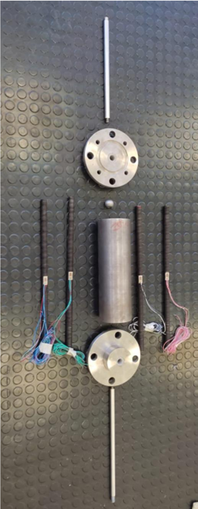
Figura 3A.6 Totalidad de piezas del disipador.
