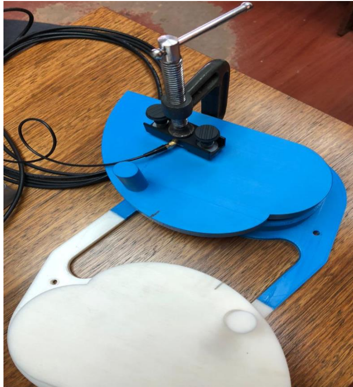
Figura 5.10: Fijación del sensor por medio de una prensa tipo c
