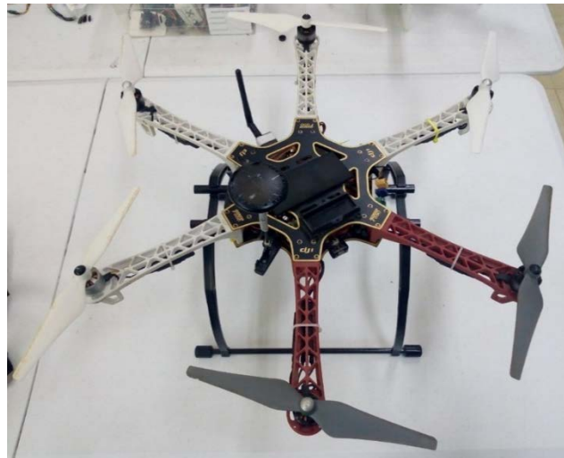
Figura 7. Dron hexarotor F550 a utilizar en las prueba de vuelo.
