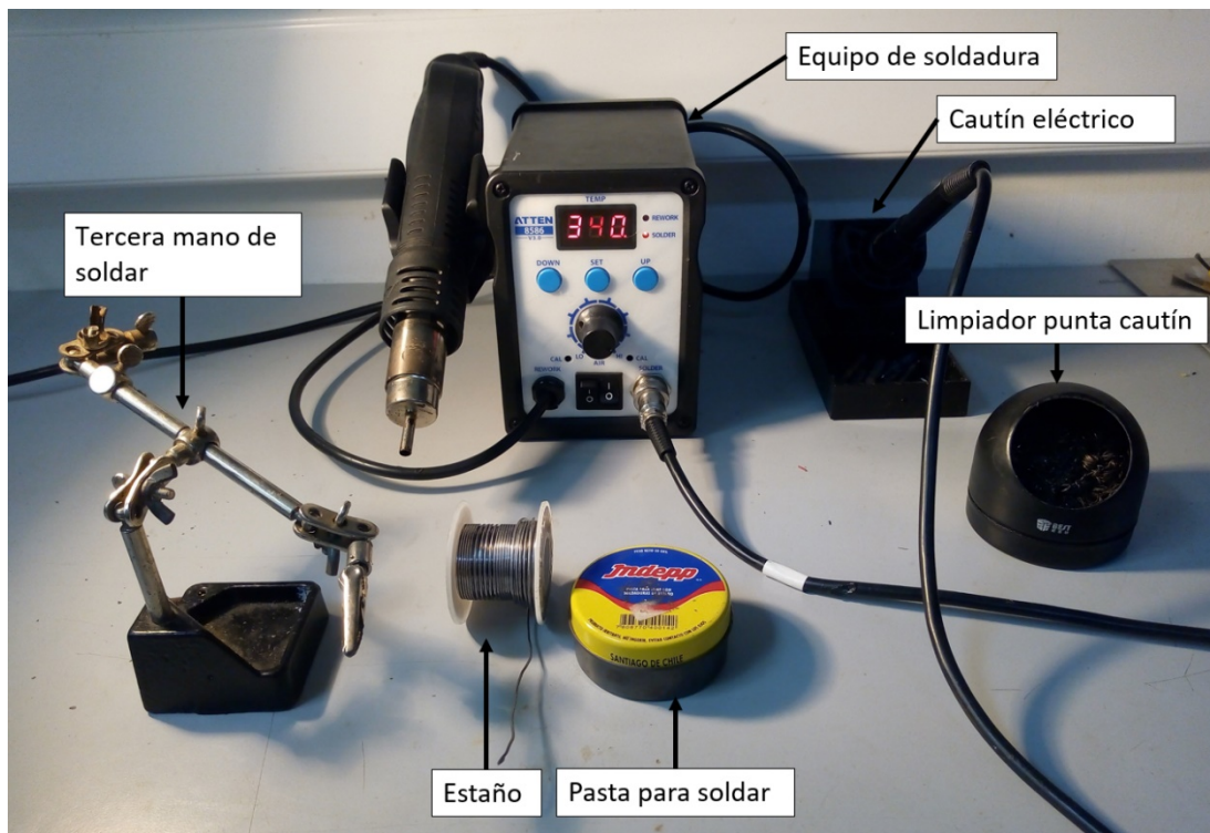
Figura 49. Equipo de soldadura utilizado.
