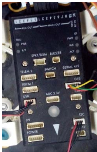
Figura 5. Autopiloto modelo HKPilot32 de HobbyKing, que se encuentra equipado en el dron F550.
