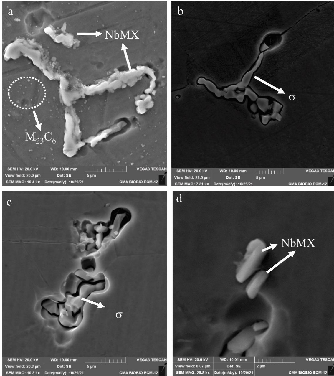
Fig. 16. Morfología de SASSNbT1 y SASSNbT2. a) Nb-MX y M_{23}C_6 en SASSNbT1 b) \sigma en SASSNbT1, c) \sigma en SASSNbT2, d) Nb-MX en SASSNbT2. Fuente: Elaboración propia.
