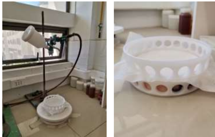
Figura 13. Arreglo utilizado para la formación nebulizada de películas. Pistola a presión con aire (izquierda) y bastidor de 15cm de diámetro (derecha).
