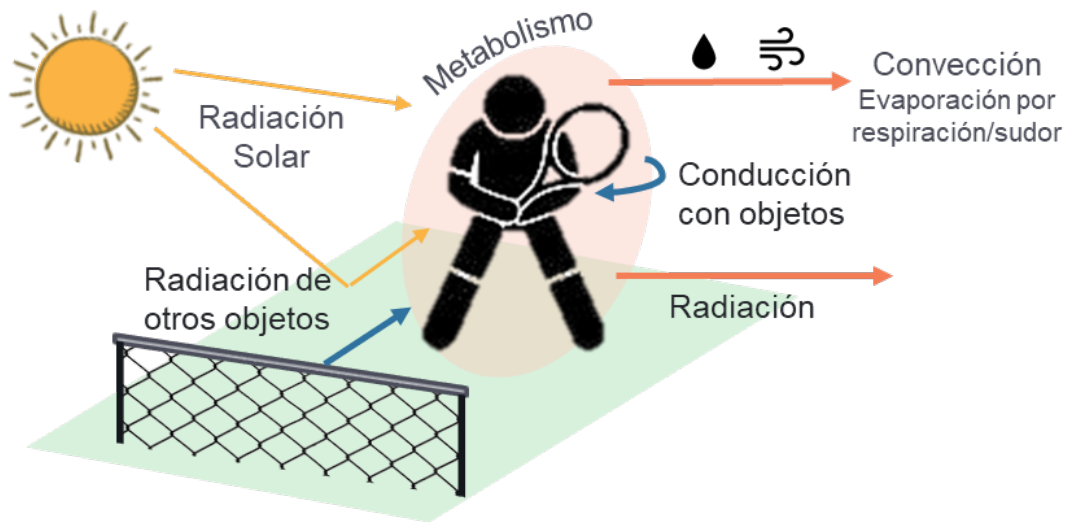
Figura 2.1.1: Transferencia de calor cuerpo humano. Fuente: Elaboración Propia.
