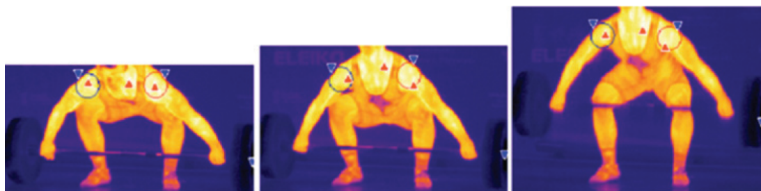
Figura 2.3.4: Resultado estudio de variación de temperatura en los hombros de levantador de pesas.
