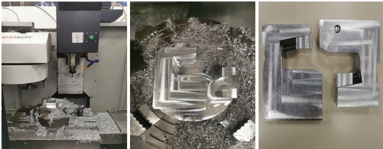
Figura 4.7: Proceso de fabricación de mordazas para ensayo Iosipescu.
