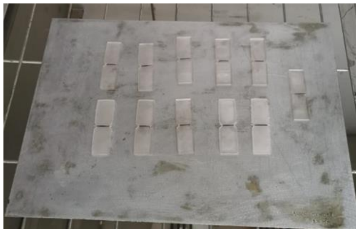
Figura 4.6: Probetas V-notch en el horno tras el proceso de post curado. Fuente: Elaboración propia
