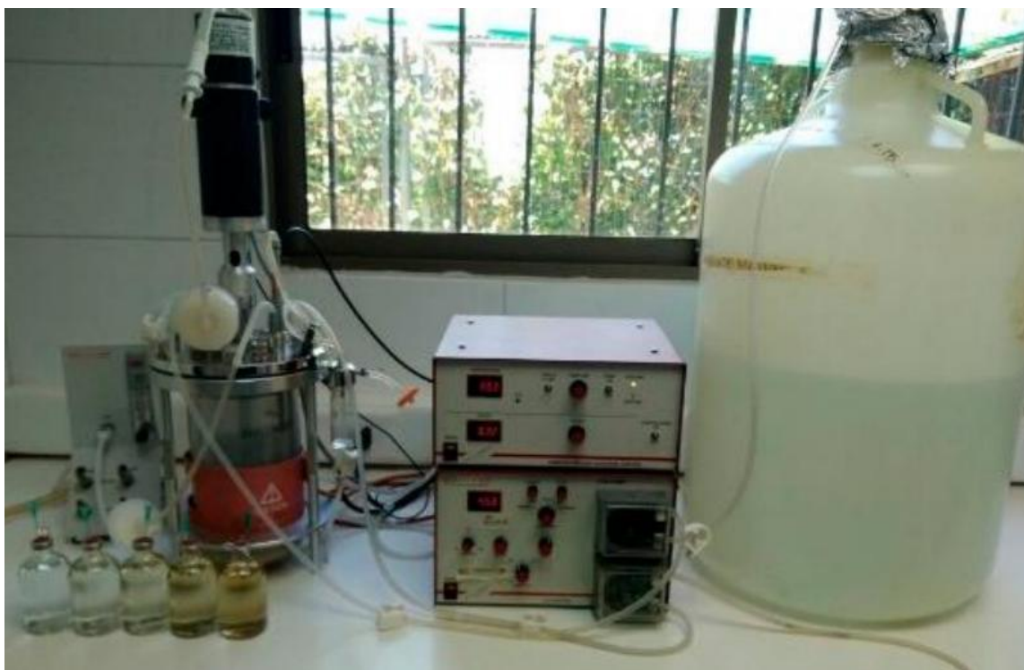
Figura 4.2: Bioreactor y sistema de alimentación. (Extraído desde [25])
