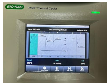
Figura 7. Programación de ciclos para detección de bacterias mediante los partidores 27F y 1492R.
