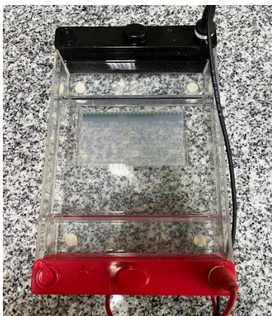
Figura 9. Cámara de electroforesis para verificación del ADN por electroforesis en gel de agarosa.
