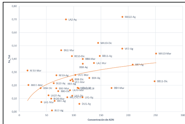
Figura 37. Diagrama de dispersión con línea de tendencia exponencial para concentración de ADN y hierro total (Sin datos de estación Guaqui).
