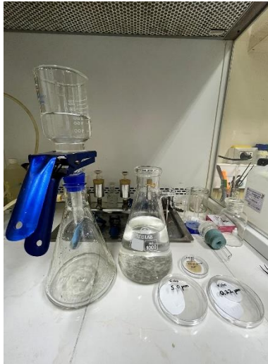
Figura 3. Sistema de filtración de muestras de agua del río Biobío.
