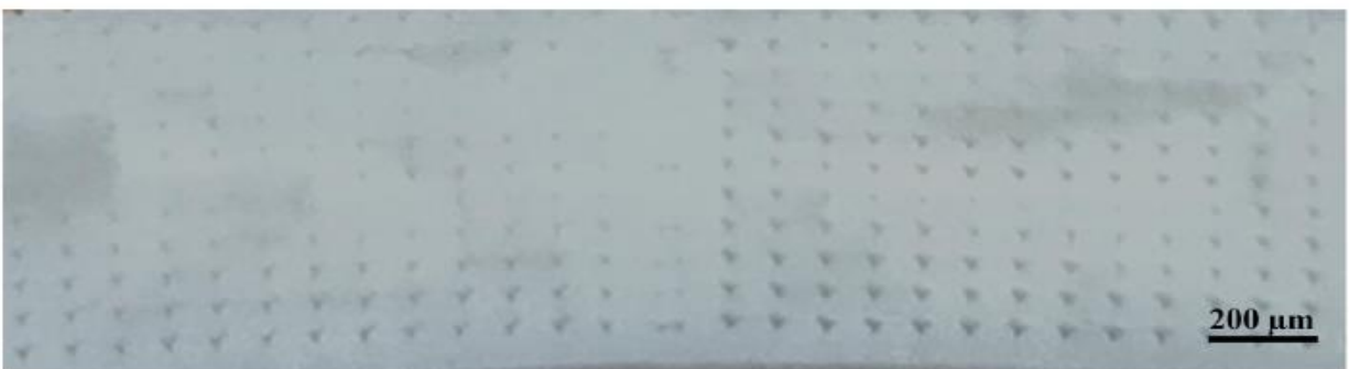
Figura 3: Espacios entre filamentos después del tratamiento térmico (Fuente: [6])
