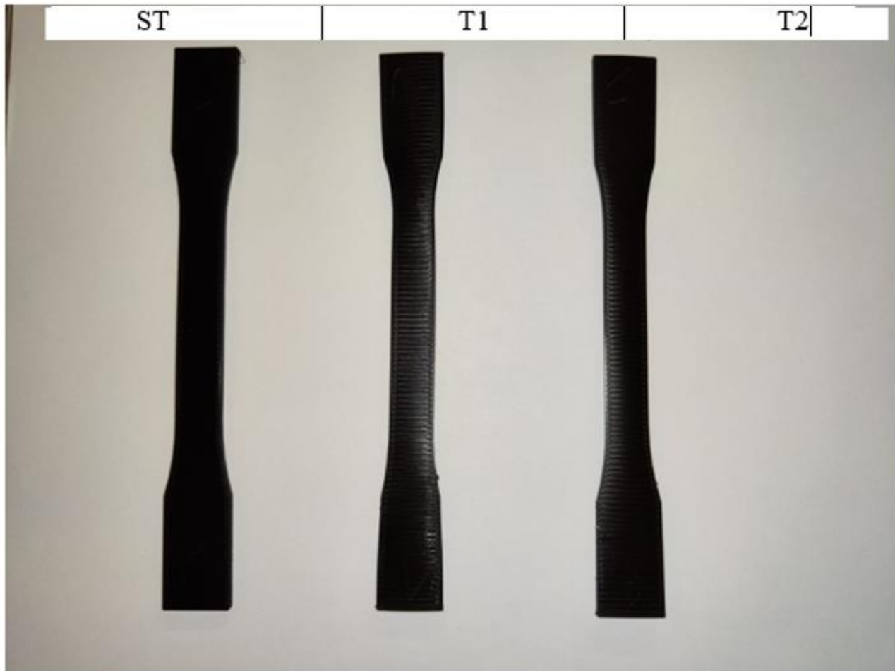
Figura 17: Probetas con orientación de 90° con los distintos tratamientos.
