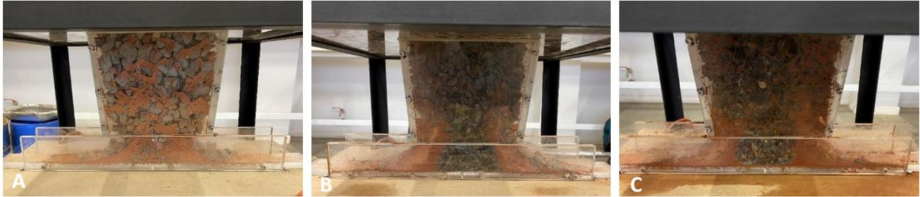
Figura 33. Condiciones finales en los puntos de extracción de cada composición experimental tras #100 extracciones. A: 0% humedad del material grueso. B: 2% humedad del material grueso. C: 4% humedad del material grueso.
