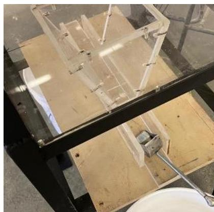
Figura 18. Pala de extracción de material que representa un LHD de  $10 \text{ m}^3$  ( $13 \text{ yd}^3$ ) escalado.
