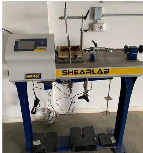
Figura 37. Máquina para ensayo de corte directo Shearlab de Matest.
