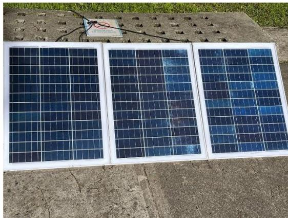
**Fig. 6.4 Arreglo de paneles ESUN de 150 W.**
