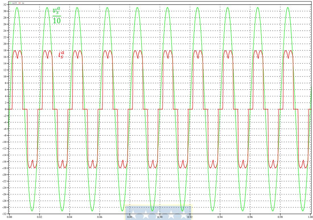
Figura 34 Voltaje ( $v_s^a$ ) y Corriente ( $i_s^a$ ), visto desde la fuente; THDi  $\approx$  28%
