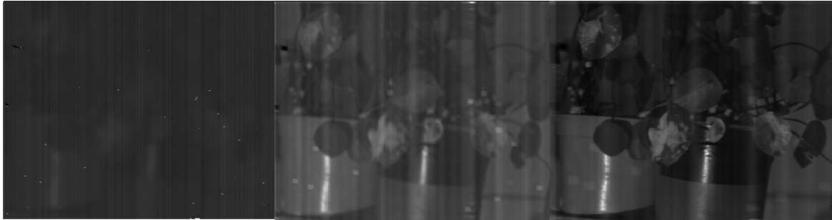
Figura 3.14: Plantas re-enfocadas en el SWIR. De izquierda a derecha se muestra como el reenfoque va limpiando de ruido la escena hasta eliminar el ruido y enfocar las plantas.
