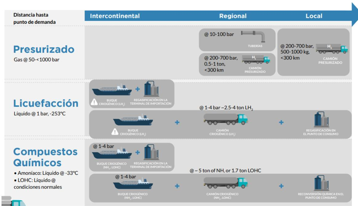
Figura 3.8. Mecanismos de transporte de hidrógeno según distancia a recorrer [12].
