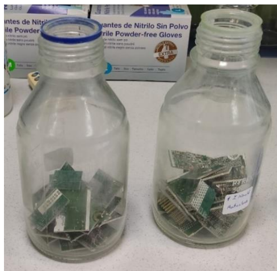
Figura 5 PCB con tamaño reducido en botellas Schott para eliminación del recubrimiento.
