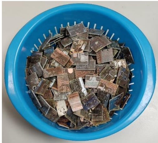
Figura 7 PCB luego del pretratamiento de eliminación del recubrimiento.
