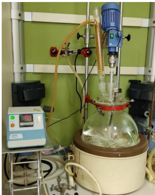
Figura 9 Reactor utilizado en la etapa de preparación de material con \text{HNO}_3 .
