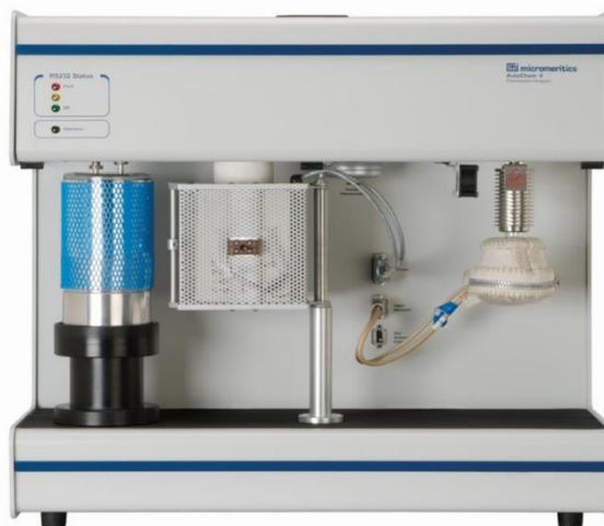
**Figura 10.** Equipo Micrometrics Autochem II.
