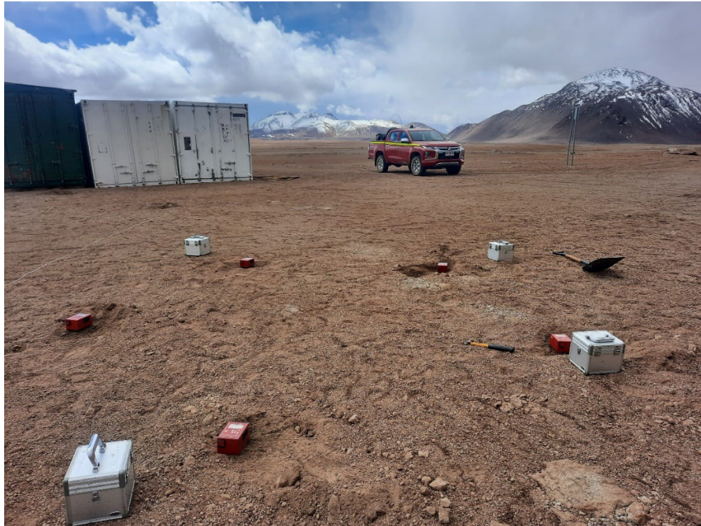
Figura A.2.2.2 Arreglo en terreno del sitio de estudio (Pentagonal lado 2 m)
