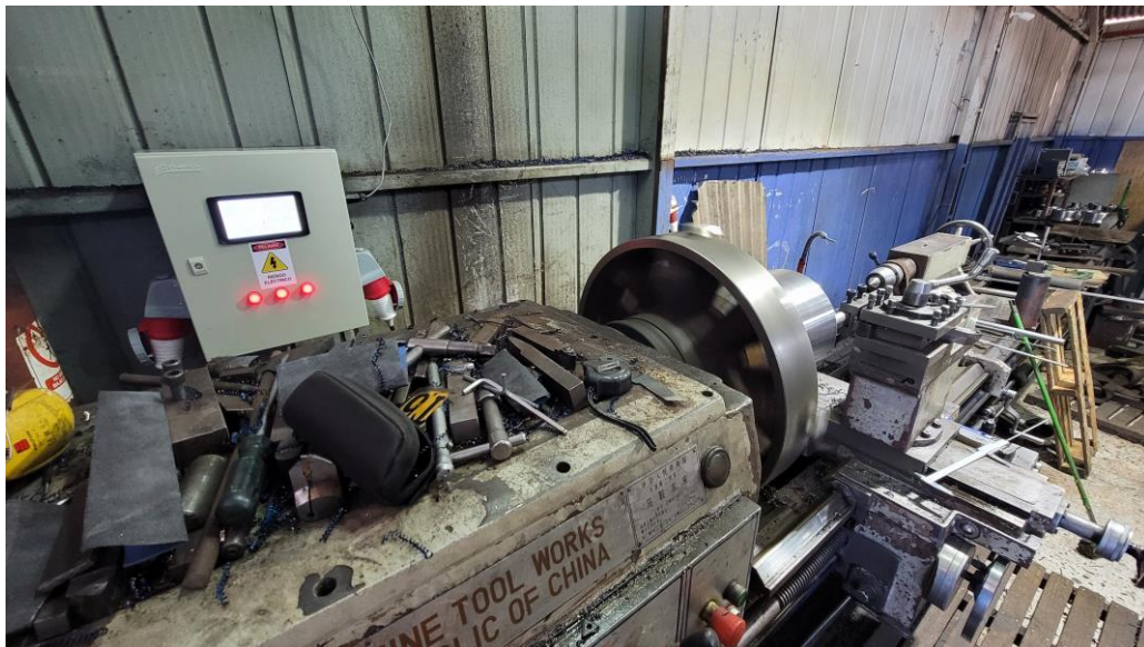
Figura 5.8: Implementación de sistema de monitoreo de consumo eléctrico.
