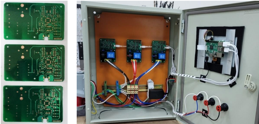
Figura 5.7: Fabricación de PCB y ensamble del sistema prototipo.
