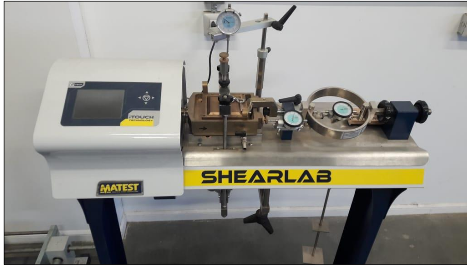
Figura 11: Equipo Matest S276 para Ensayos de Corte Directo
