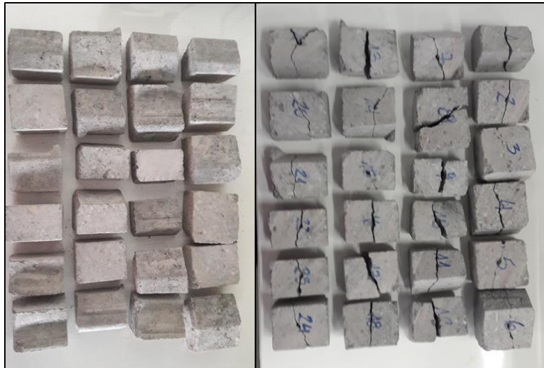
Figura 9: Testigos de Adocreto Antes (derecha) y Después (izquierda) de los Ensayos de Carga Puntual
