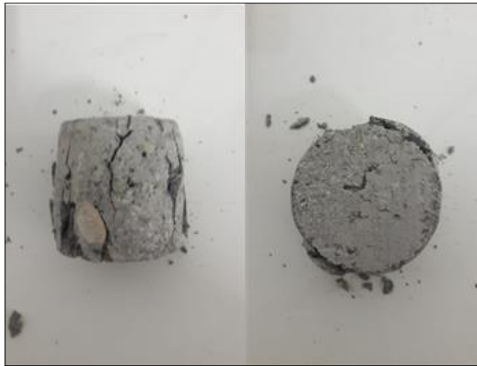
Figura 35: Testigo de Solerilla Tras el Ensayo de Compresión Uniaxial
