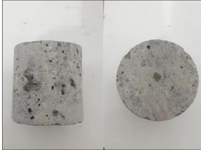
Figura 34: Testigo de Solerilla Antes del Ensayo de Compresión Uniaxial
