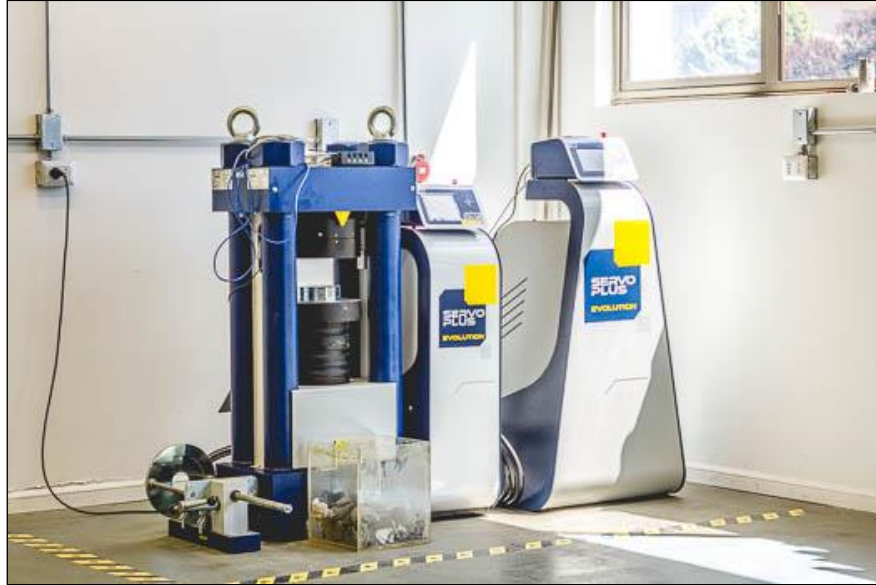
Figura 5: Equipo Servoplus de Matest para Pruebas de Compresión
