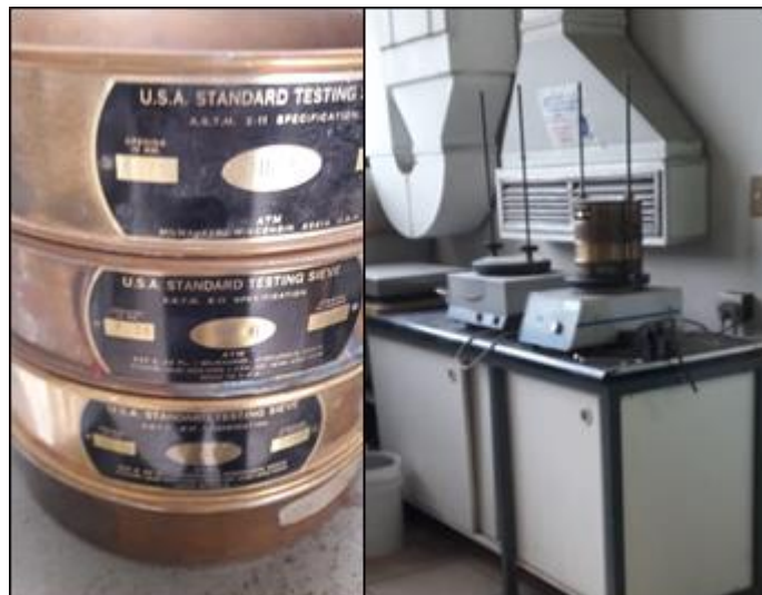
Figura 18: Ro-tap Utilizado para Clasificación de Material Inferior a 5 mm
