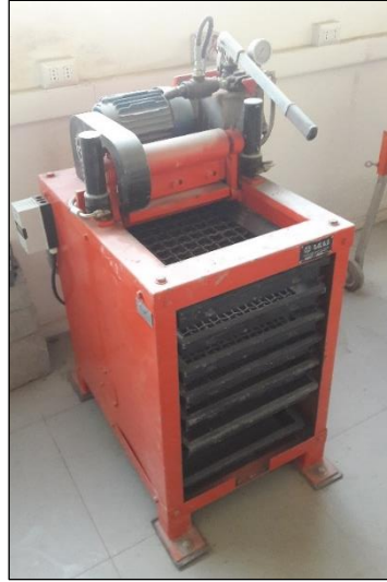
Figura 17: Harnero Utilizado para Clasificación de Material Granular Superior a 5 mm
