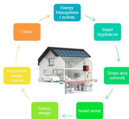
Figura 1.4: Esquema representativo de sistema de gestión de energía domiciliario. Fuente: Hybridized Intelligent Home Renewable Energy Management System for Smart Grids [9]
