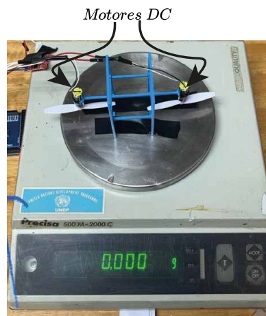
Figura 4.1: Balanza para medición de fuerza generada por motores DC.
