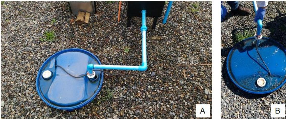
**Figura 18.** A) Estanque de recepción y conducto de aspiración operando en buenas condiciones. B) Rebalse de fluido en estanque de recepción.
